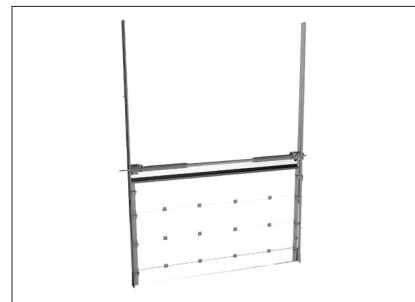
Вертикальный подъём с выносным валом.
